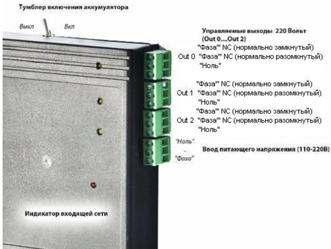
Схема подключения GSM-розетки 3-канальной
